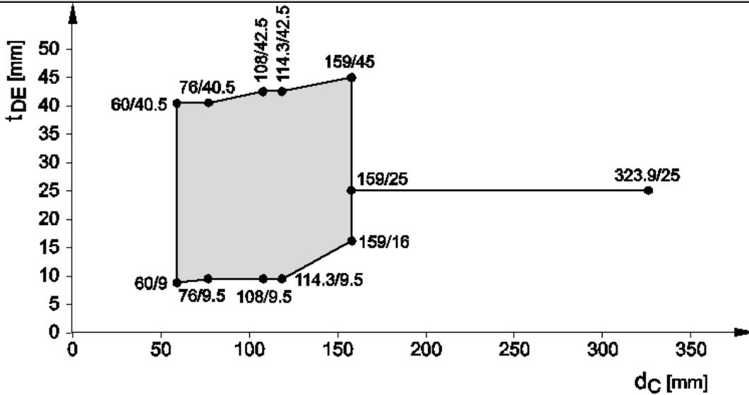
**Steel pipes ( $\varnothing$  28 - 88,9), floor ( $\geq$  150 mm) – EI 90, C/U**
