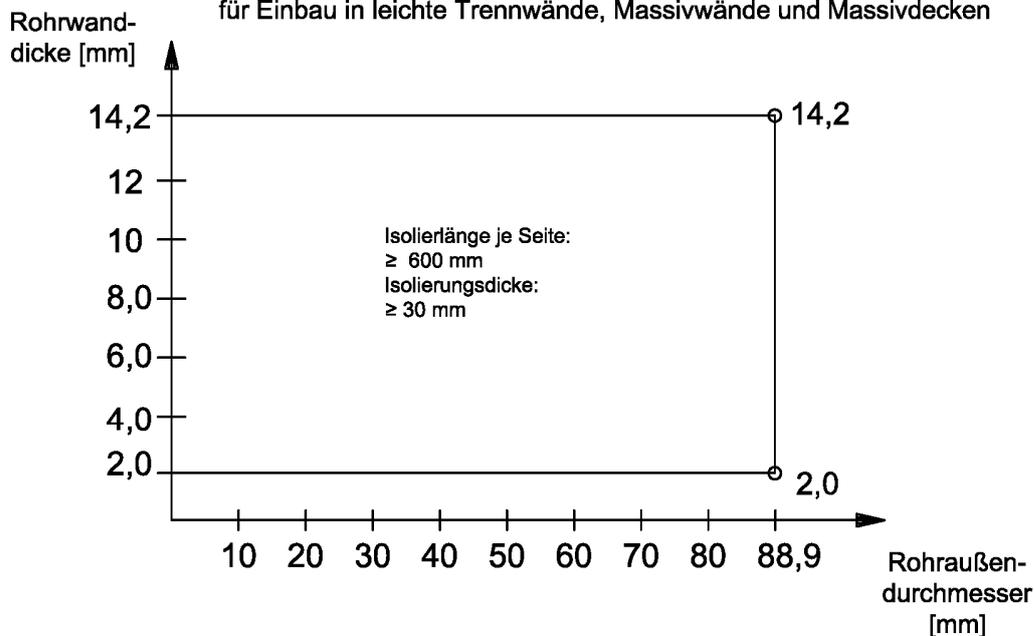
Feuerwiderstandsfähige Abschottung für elektrische Leitungen und/oder Rohrleitungen aus Kunststoff oder Metall "Hilti Brandschutz-System CFS-BL P Kombi S30"
