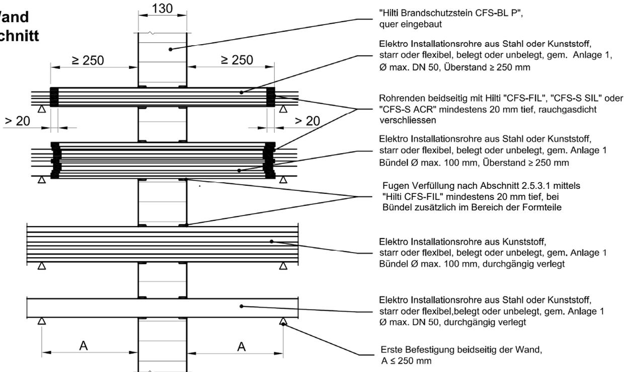
Rohrenden beidseitig mit Hilti "CFS-FIL", "CFS-S SIL" oder "CFS-S ACR" mindestens 20 mm tief, rauchgasdicht verschliessen
