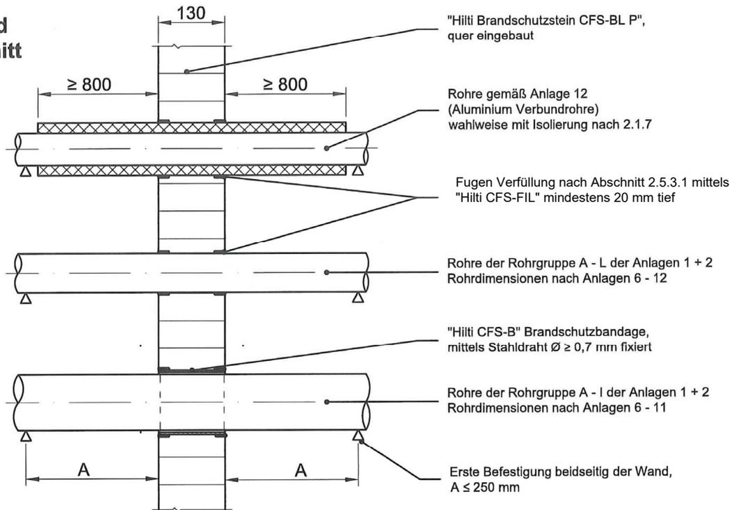
Rohre der Rohrgruppen A - I der Anlagen 1 + 2 Rohrdimensionen nach Anlagen 6 - 11
