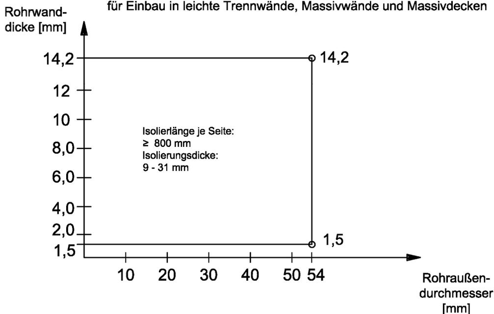
Feuerwiderstandsfähige Abschottung für elektrische Leitungen und/oder Rohrleitungen aus Kunststoff oder Metall "Hilti Brandschutz-System CFS-BL P Kombi S30"
