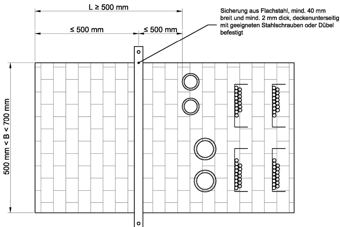
Feuerwiderstandsfähige Abschottung für elektrische Leitungen und/oder Rohrleitungen aus Kunststoff oder Metall "Hilti Brandschutz-System CFS-BL P Kombi S30"
