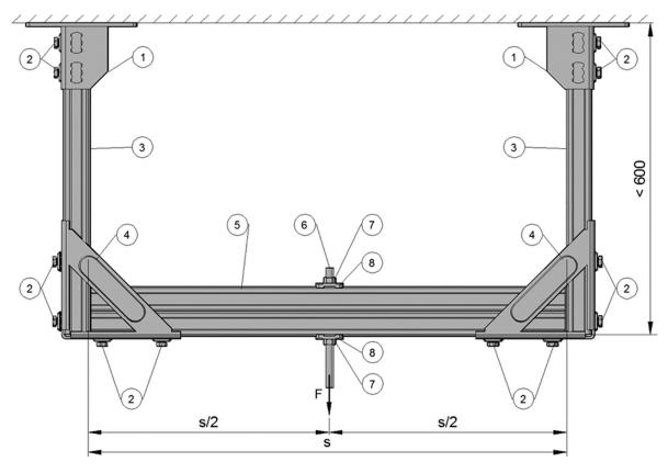
Cadre trapèze avec s = 700 mm, 1 000 mm, 1 250 mm et raccord centré pour l'introduction de charge
